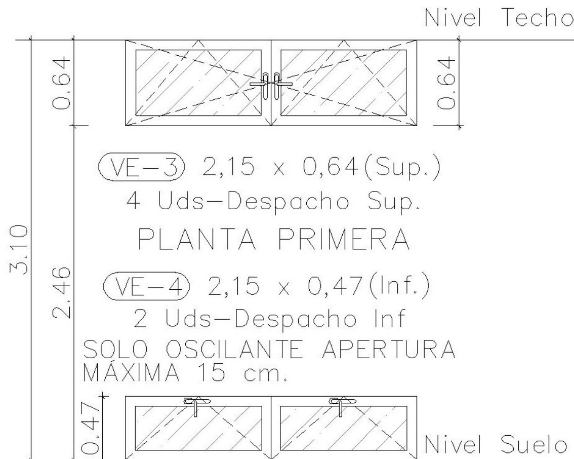
Esquema 2.- Planta Primera. Altura a las ventanas superiores 240 cm \geq 90 cm. Cumple. Altura de ventanas inferiores 0 cm < 90 cm., por lo que no podrán abrirse : Solo podrán ser
