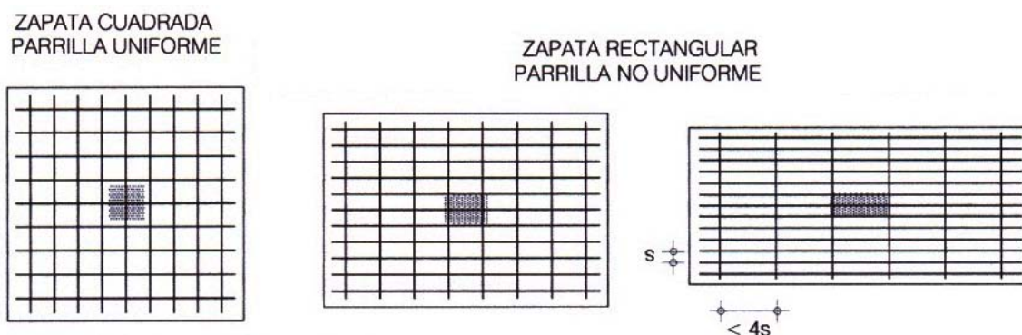
Figura 4.3. Armado de zapatas
